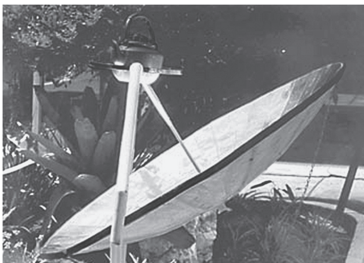
Fogão solar aquecendo um chaleira.
