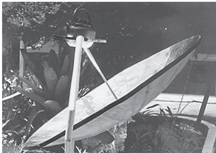
Fogão solar aquecendo um chaleira.
