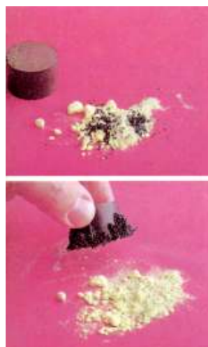
A limalha de ferro e o enxofre podem ser afastados por separação magnética.
