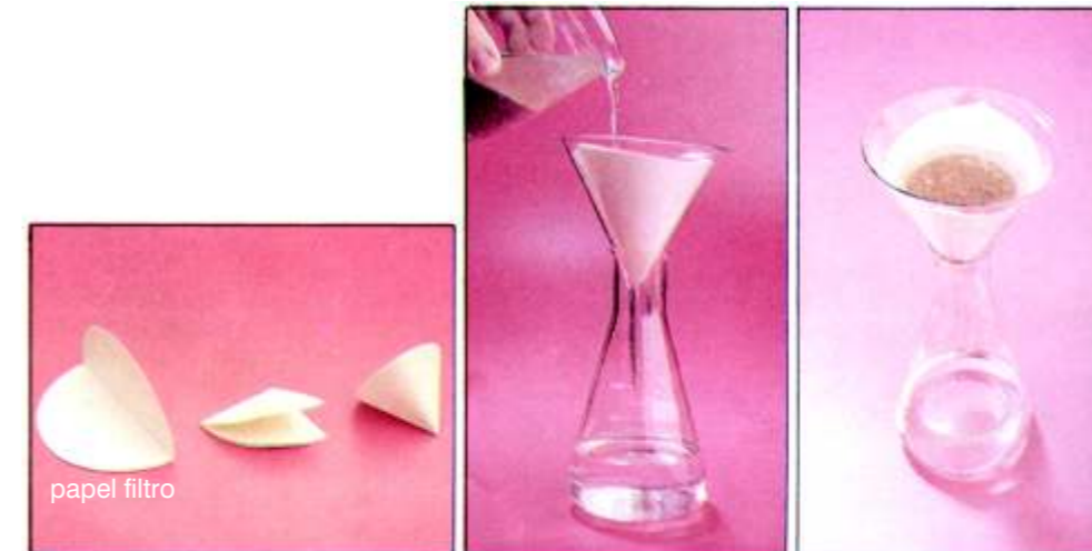
A filtração da mistura sólido-líquido é feita comumente em laboratório, por meio de papel filtro adaptado em funil.
